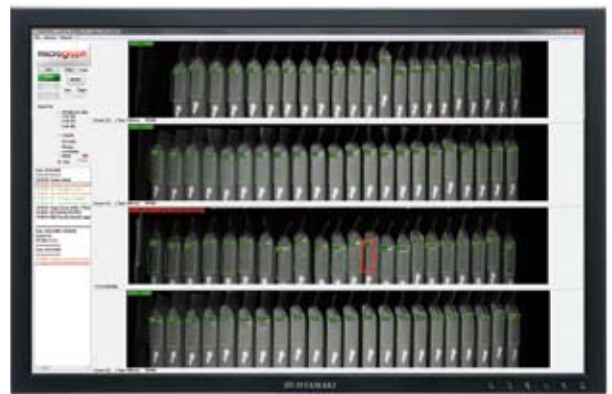
Screenshot der microglyph® Decoder Software im Einsatz an den Verpackungslinien. Jeweils vier Verpackungskartons werden parallel verarbeitet. Die grünen Markierungen zeigen die i.O.-Produkte, die rote Markierung zeigt ein Nicht-i.O.-Produkt mit nicht tolerierter Abweichung der Packmittelposition. Der betroffene Karton wird angesteuert.
